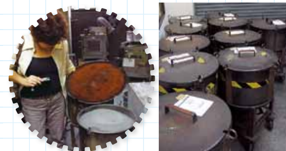
鉄や銅など、様々な種類の金属粉が原材料。金属の種類や配合が異なる原材料が大量に用意されている。
