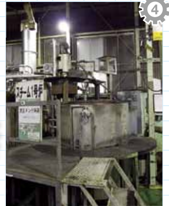
プレスされたギヤやブリーは温度管理された長い炉の中で移動しながら焼かれる。炉が稼動している間は工場内の温度は40度以上にもなる。
