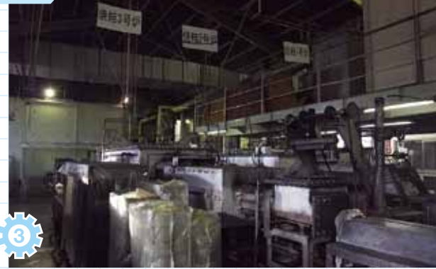
プレスされたギヤやブリーは温度管理された長い炉の中で移動しながら焼かれる。炉が稼動している間は工場内の温度は40度以上にもなる。
