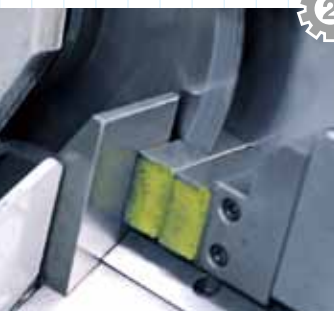
研 磨された冷間引抜材は大きな 歯のカッターでカットされる
