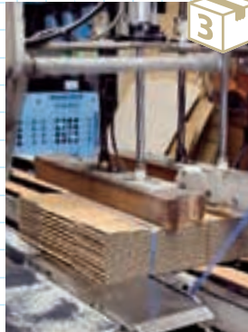
右)出来上がったA式のダンボールは最後に結束。左)実際に組み立てて説明してくれる荒江社長。
