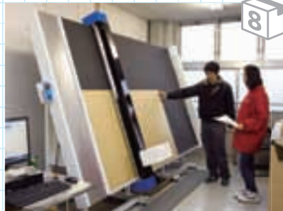
キャドに接続された大きなカッターで小ロットのダンボールも瞬時に作られる。
