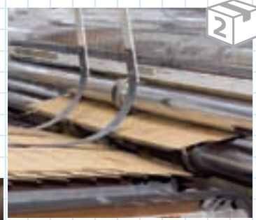
上)A式のダンボールを作る大きな機械。 右下・左下)材料となる長方形に裁断された状態の ダンボールを機械にセットする。左)樹脂で作った印刷 の版。
