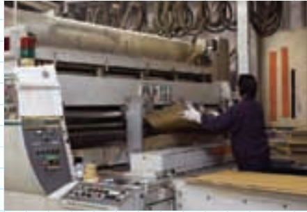
上)A式のダンボールを作る大きな機械。 右下・左下)材料となる長方形に裁断された状態の ダンボールを機械にセットする。左)樹脂で作った印刷 の版。
