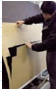
キャドに接続された大きなカッターで小ロットのダンボールも瞬時に作られる。
