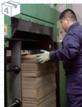
右)N式ダンボールを作る機械。左)赤い部分に刃が埋め込まれているN式の抜き型。
