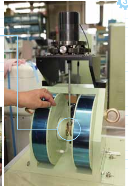
右) 振動試料型磁力計で実際に磁気テープの磁気を計測するところ。上部の黒い筒が振動を与える部分。上) 磁気テープは磁極間にセットされる。下) 詳しく説明してくれる今井社長。
