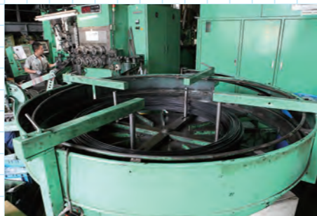
大きなロール状の鋼線が原材料。専用の機械にセットされ図面通りに成形される。
