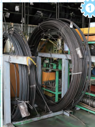
大きなロール状の鋼線が原材料。専用の機械にセットされ図面通りに成形される。
