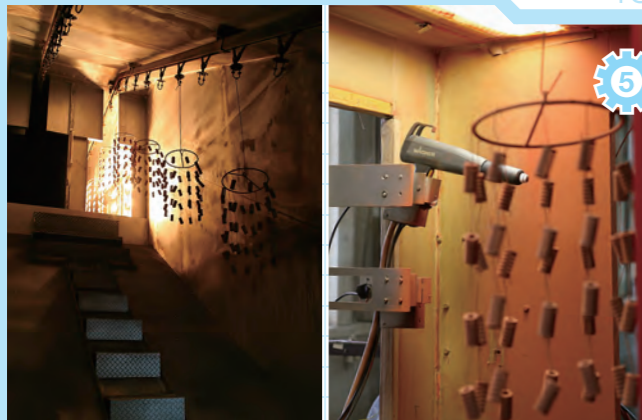
塗装も全てコンピュータ制御された機械で行われて いる。自動スプレーガンで塗装された後コンベアを移 動し乾燥させて完成となる
