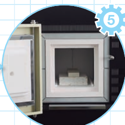
切断し研磨された後は電気炉で加熱される
