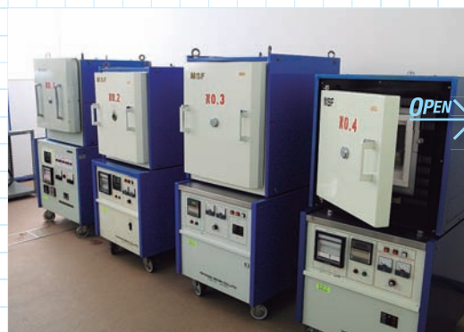
切断し研磨された後は電気炉で加熱される
