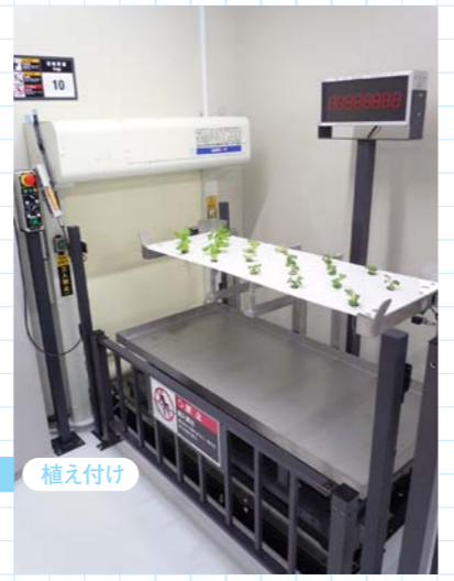
発芽し、葉が3枚程度になったら定植トレイに植え付け、LED環境の栽培棚に移動
