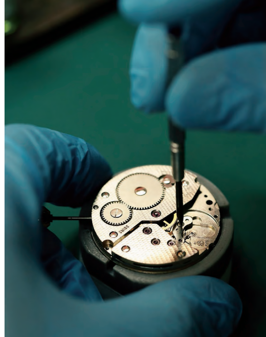
スイス製ユニタス6498のオーバードライバー。同型大判の手巻ムーブメントは多くの有名ブランドにキャリバーが供給された
