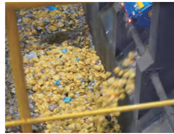
5/ 町田市内から回収した燃やせるごみは、プラットフォームからごみピットへ集められます。
